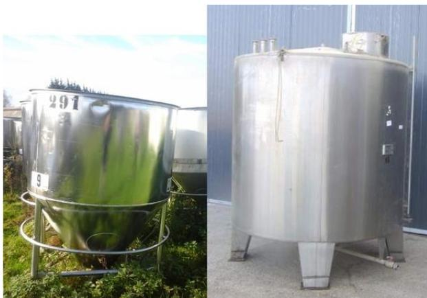
**Celle de gauche servira de nouvelle cuve de trempage.** Pour faire germer le grain d'orge, il faut le réveiller. Cela passe par son hydratation. Il va ainsi passer au bout d'un cycle d'environ 36 heures de 15 à 43% d'humidité.
